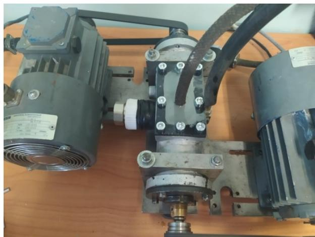
Рис. 3. Оборудование для обработки оптических изделий свободным абразивом с применением эффекта вихревой кавитации
