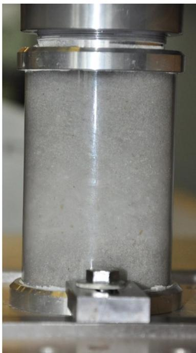
Рис. 1. Фото процесса обработки детали свободным абразивом с применением эффекта присоединенной кавитации
