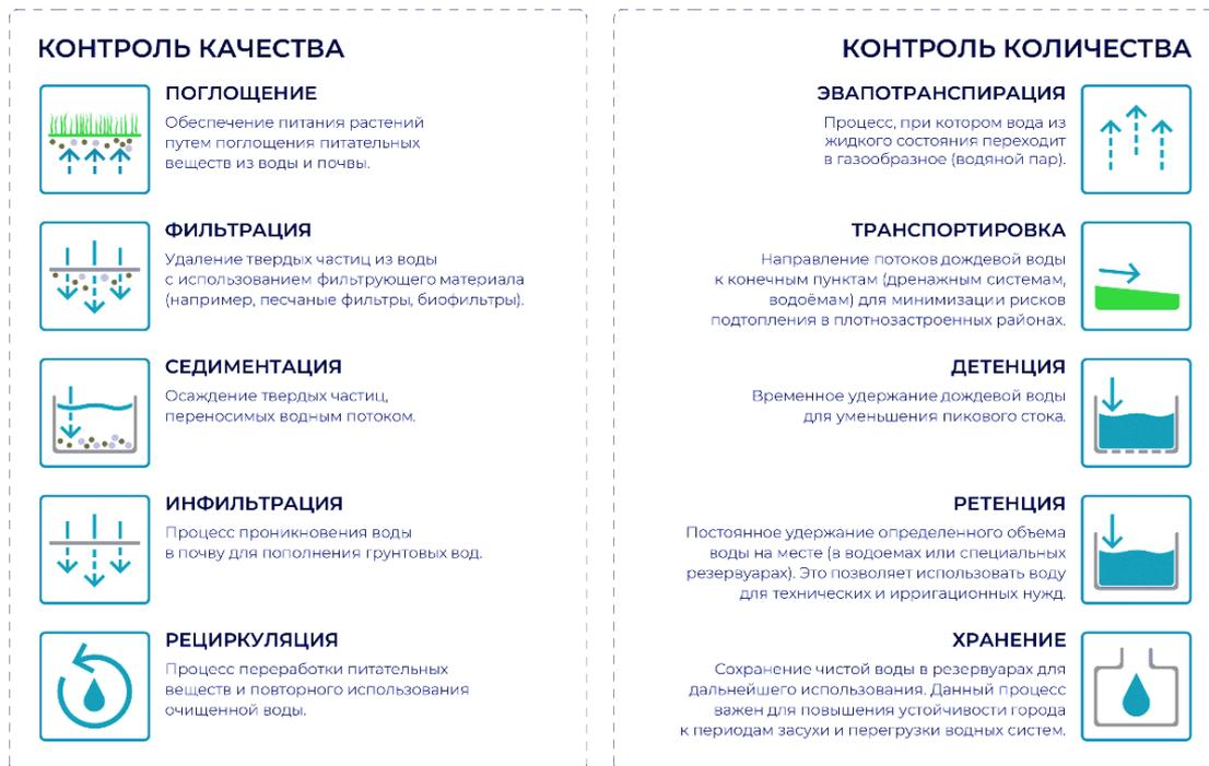
Рис. 4. Классификация методов водосберегающего проектирования. Разраб. Дубино А.М.
